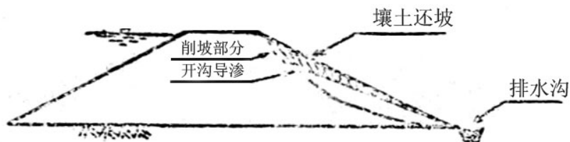
图 1.5 开沟导渗滤水还坡
